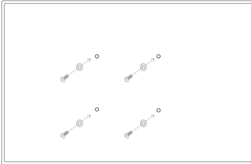
Schrauben Sie nun die Montageschrauben rückseitig in den Bildschirm ein (4x M8-Schrauben mit passender Unterlegscheibe). Schrauben bitte vorsichtig einschrauben und anziehen um Beschädigungen am Gerät zu vermeiden. Die passenden Schrauben und Unterlegscheiben finden Sie in dem mitgelieferten TV-Schraubenbeutel.
