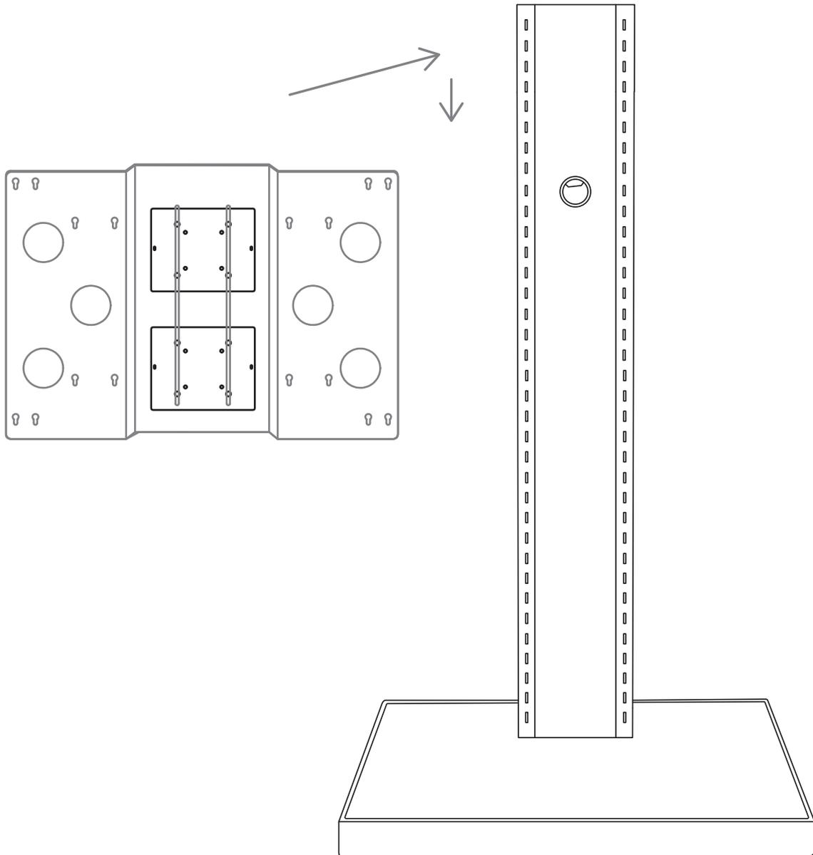
Hängen Sie die VESA-Schwerlastaufnahme / VESA-Montageplatten in der gewünschten Höhe in die Raststufen der Säule ein.
