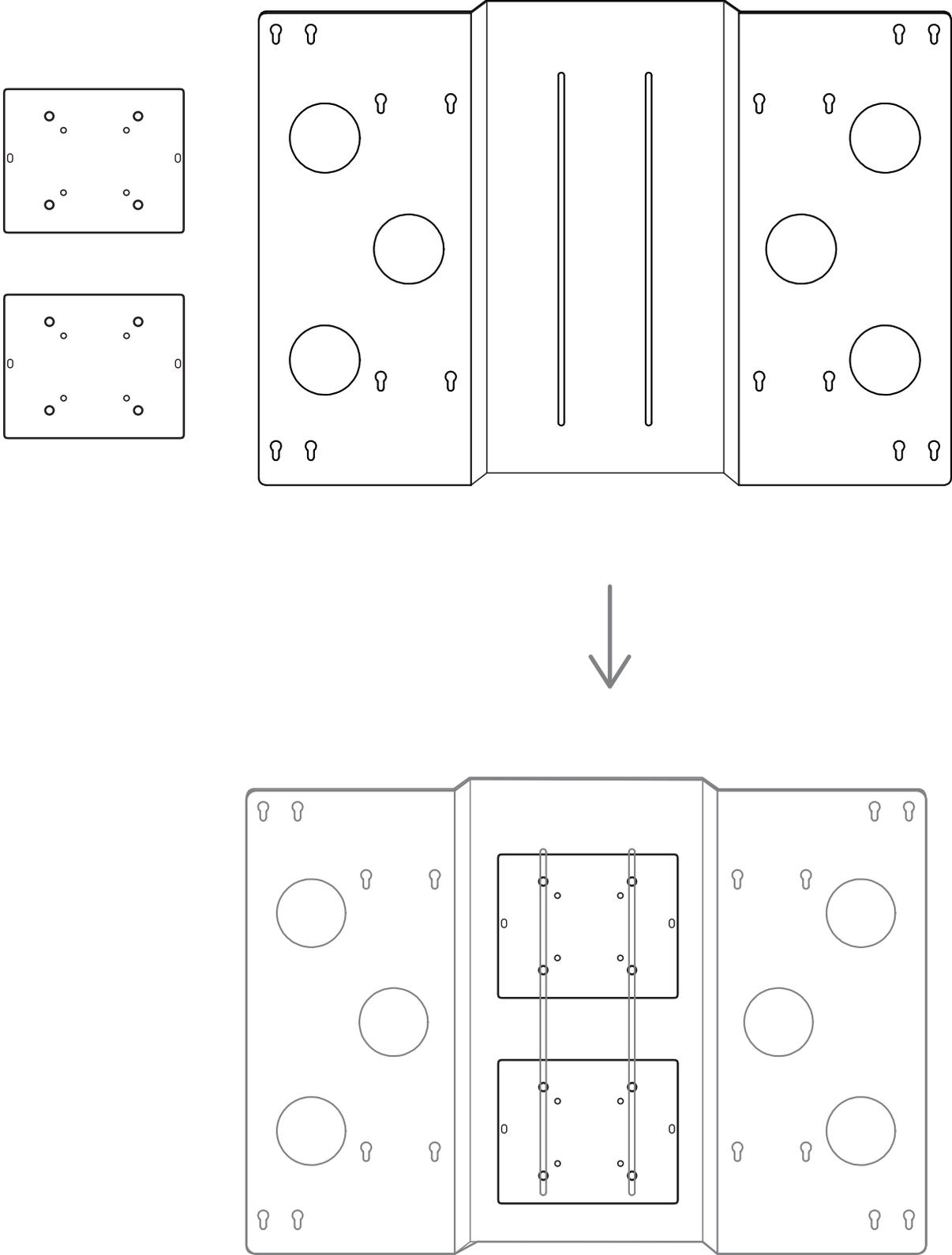
Verschrauben Sie die VESA-Schwerlastaufnahme mit den beiden VESA-Montageplatten.
