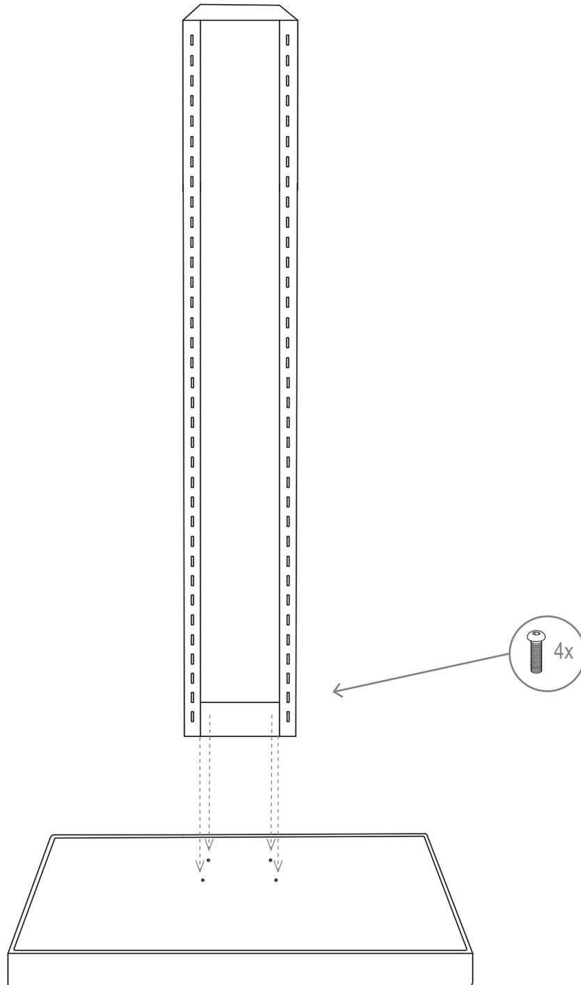
Legen Sie die Standsäule auf eine weiche Unterlage um Beschädigungen zu vermeiden. Verschrauben Sie die Bodenplatte mit der Standsäule, verwenden Sie hierfür die M8X45 Linsenkopfschrauben. Richten Sie die Säule anschließend vorsichtig auf.
